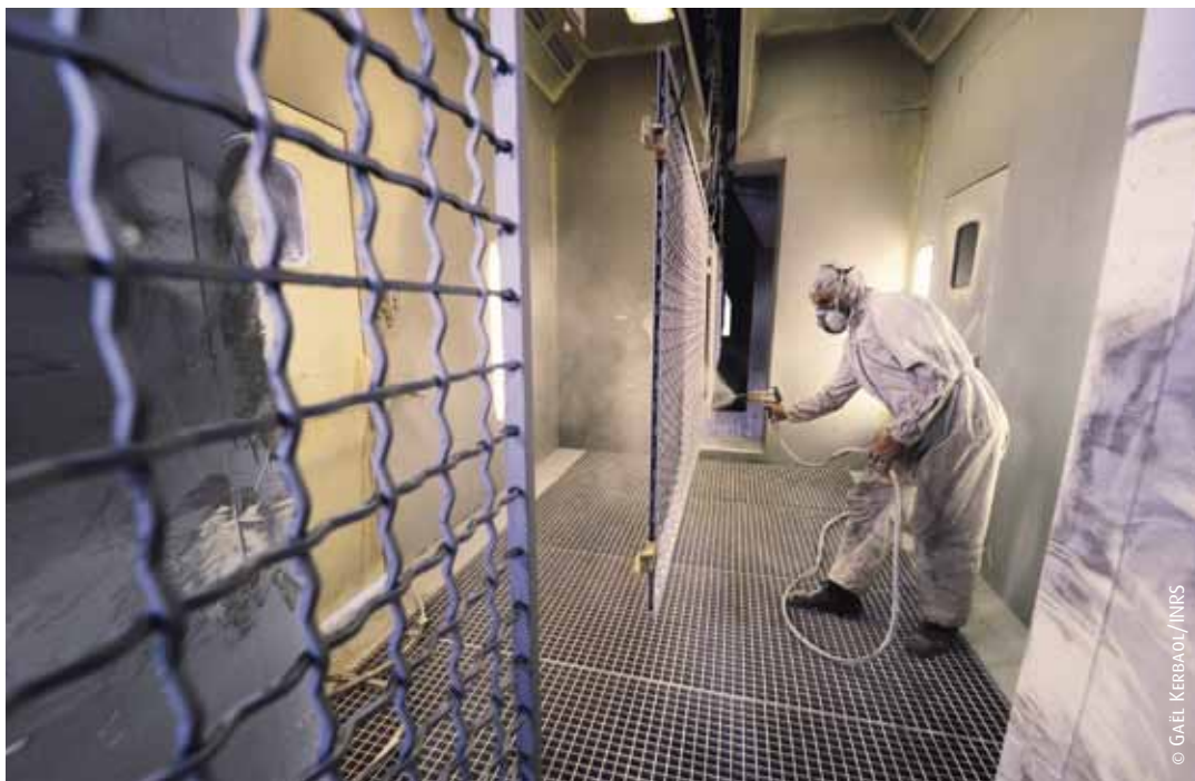
La première cabine de poudrage est utilisée pour des pièces allant jusqu'à 2 m de haut, 60 cm de large, 6 m de long et 400 kg.
